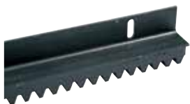
ACS9090 РЕЙКА Module 6 стальная (сеч. 30 x 30 мм ) с КАТАФОРЕЗНОЙ обработкой, с полкой 45x45 мм секциями по 2 м
