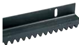
ACS9080 РЕЙКА Module 6 стальная (сеч. 30 x 30 мм ) с полкой 45x45 мм секциями по 2 м
